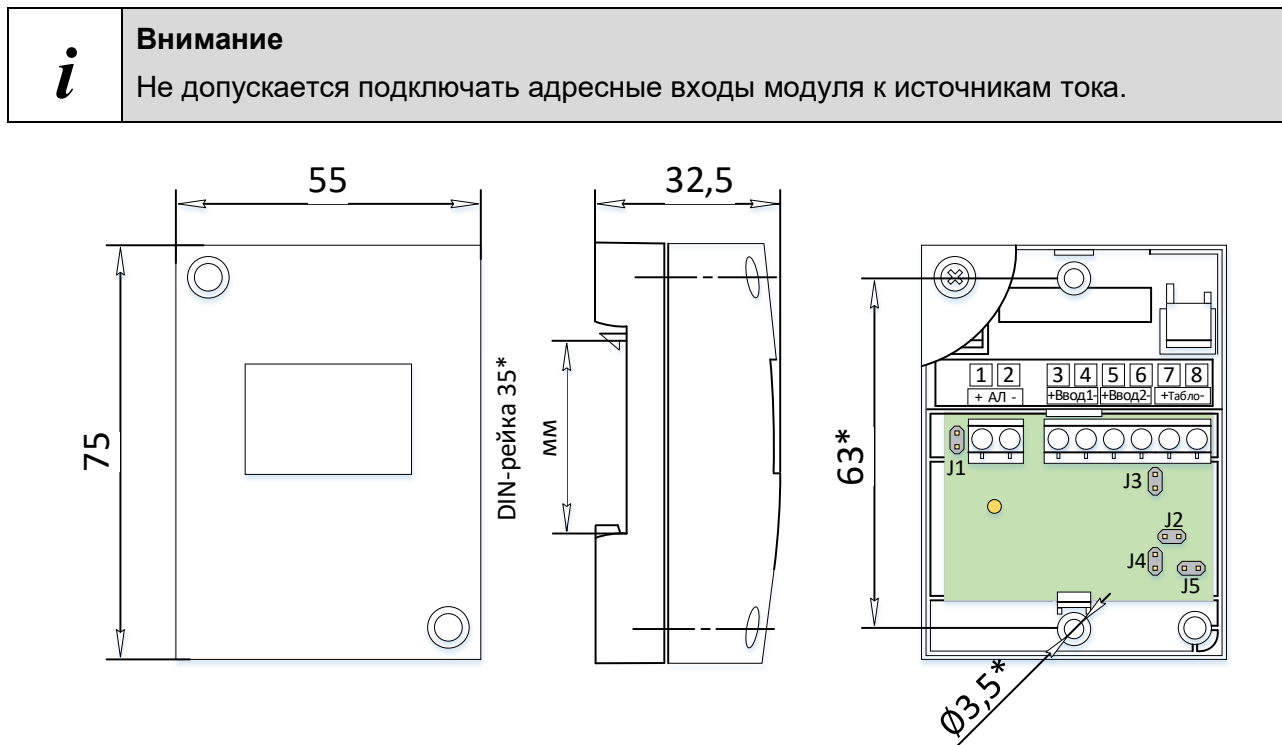
Рис.1. Габаритные и установочные размеры модуля.
