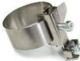
При отсутствии возможности установки заземляющего устройства на вводную муфту вв или вму, заземление металлорукава выполняется с помощью хомута заземления промрукав. Это устройство заземления возможно установить в любом наиболее удобном месте. Хомут устанавливается на металлорукаве и с помощью винтового зажима, зажимается на нем.
