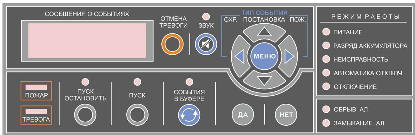
Рис.12. Органы управления и индикации АПКП «Юнитроник 496М».
